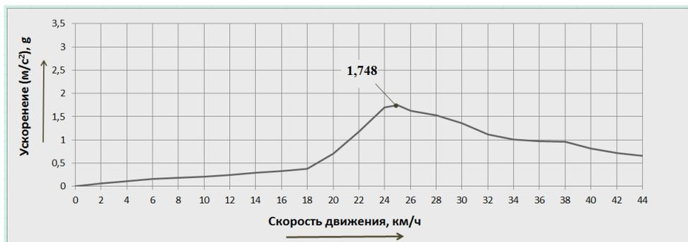
Рисунок 5 – СКО вертикальных ускорений на месте механика-водителя/экипажа при движении изделия БТР-4 с управляемыми амортизаторами по стандартной трассе
