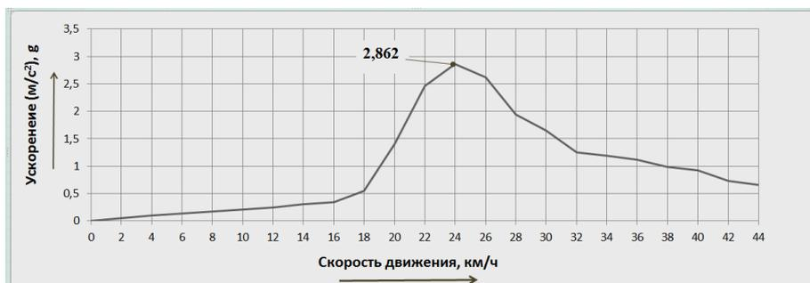
Рисунок 4 – СКО вертикальных ускорений на месте механика-водителя/экипажа при движении изделия БТР-4 по стандартной трассе
