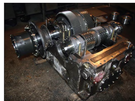
Рис. 6. Мультипликатор М40-16-5,3/11,6 при сборке
