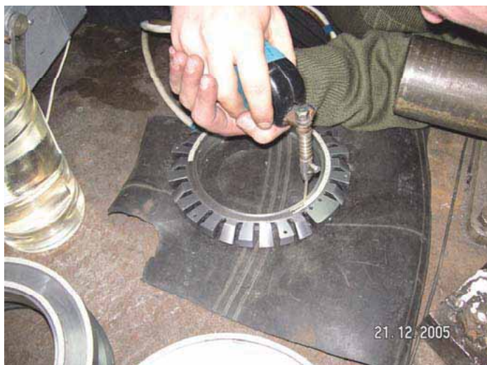
а Рис. 7. ЭЭЛ медью стали 20 перед лужением и заливкой баббитом (а) и детали с электроэрозионным покрытием (б)
