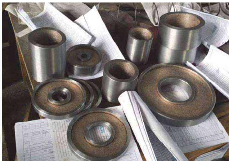
а Рис. 7. ЭЭЛ медью стали 20 перед лужением и заливкой баббитом (а) и детали с электроэрозионным покрытием (б)
