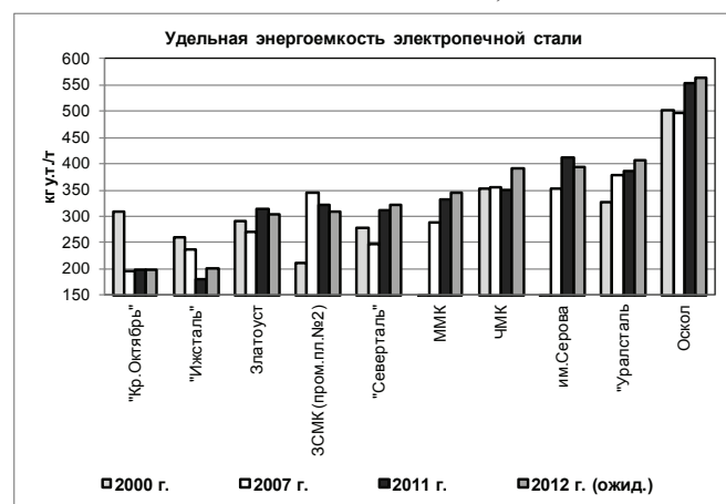
Рис. 4. Удельная энергоёмкость электростали, кг.у.т/т
