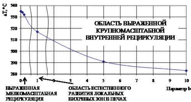
Рис. 4. Зависимость перепада температуры в печи от степени развития локальной мелкомасштабной рециркуляции печных газов (параметр b )
