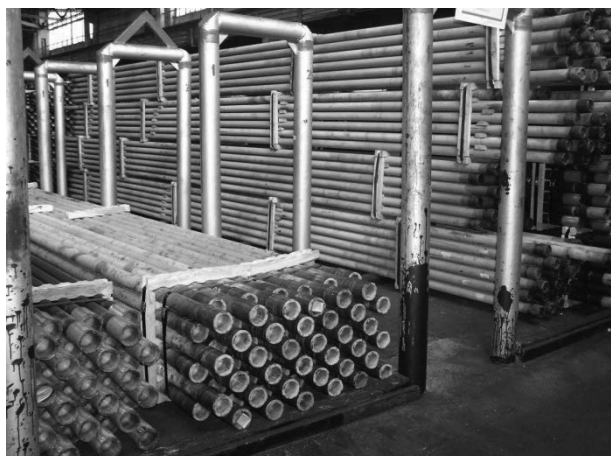
Рис. 1. Внешний вид пакетов диффузионно оцинкованных НКТ группы прочности Е для глубоких нефтяных скважин
