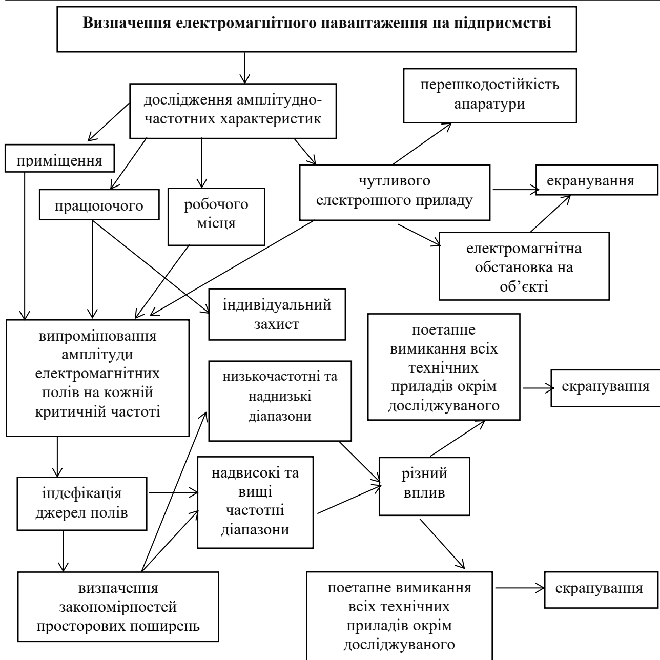
Рис. 1. Концепція визначення електромагнітного навантаження на підприємстві
