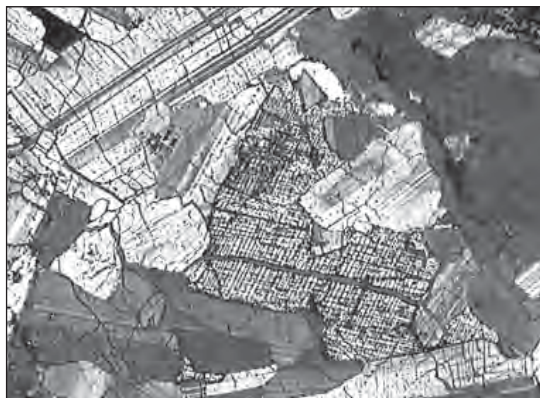
Рис. 2. Субофитовая структура лейкогаббро-долерита РБИ под поляризационным микроскопом Fig. 2. Subophitic texture of RBI leucocratic gabbro-dolerite under polarization microscope
