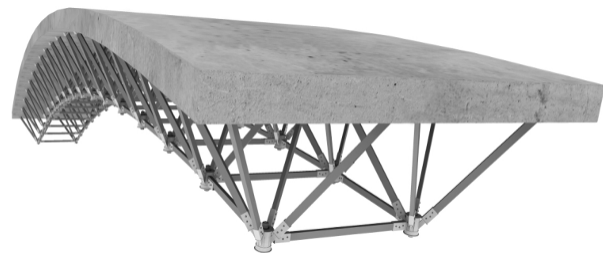
Рис. 2. Общий вид предлагаемой арочной конструкции пролетного строения
