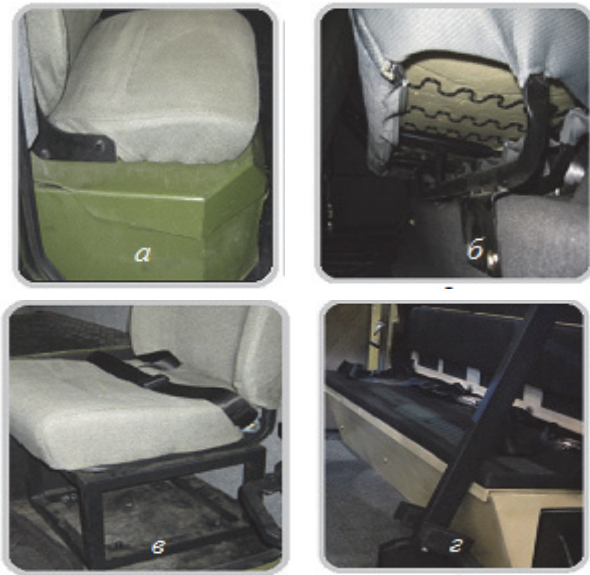
Рис. 2. Сидіння БММ вітчизняного виробництва: а, в – "Хамер"("Практика"), б – "Барс - 6" ("Богдан"), г – "Когуар"("АвтоКрАЗ")
