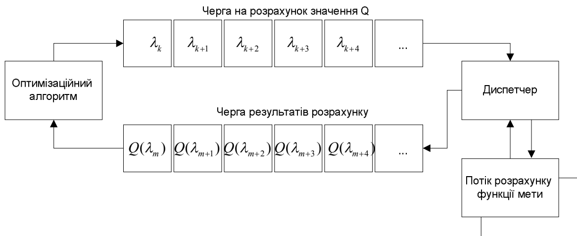
Рис. 3. Структура програмної реалізації оптимізаційного алгоритму з паралельним обчисленням функції мети
