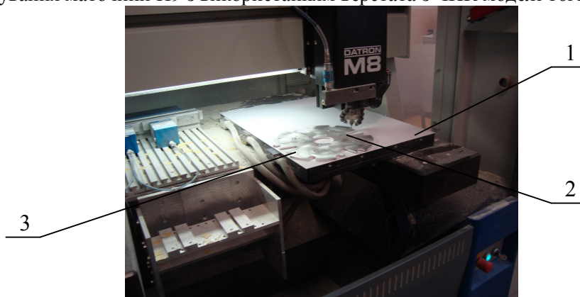
Рис. 2. Горизонтально-фрезерний верстат Datron M8: 1 – робочий стіл; 2 – спеціальна пальцева фреза; 3 – заготовка приводного диска
