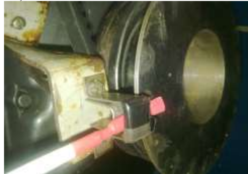
Рис. 6. Пристрій для вимірювання частоти обертання колінчастого валу двигуна.
