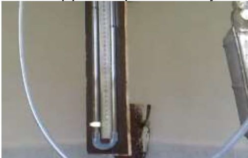
Рис. 5. Пристрій для вимірювання тиску у випускній системі двигуна.
