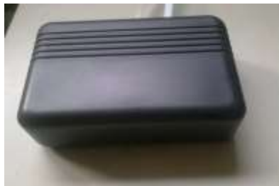
Рис. 7. Модуль програмно-апаратного комплексу для дослідження характеристик двигуна внутрішнього згоряння на основі МК ATmega16
