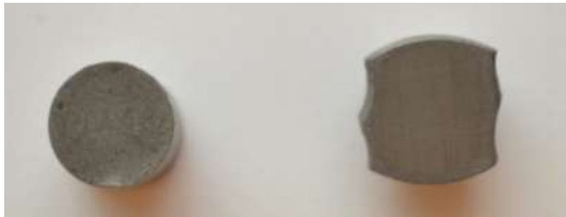
Рис. 1. - Внешний вид и продольное сечение брикетов, полученных отжигом и допрессовкой в КВД
