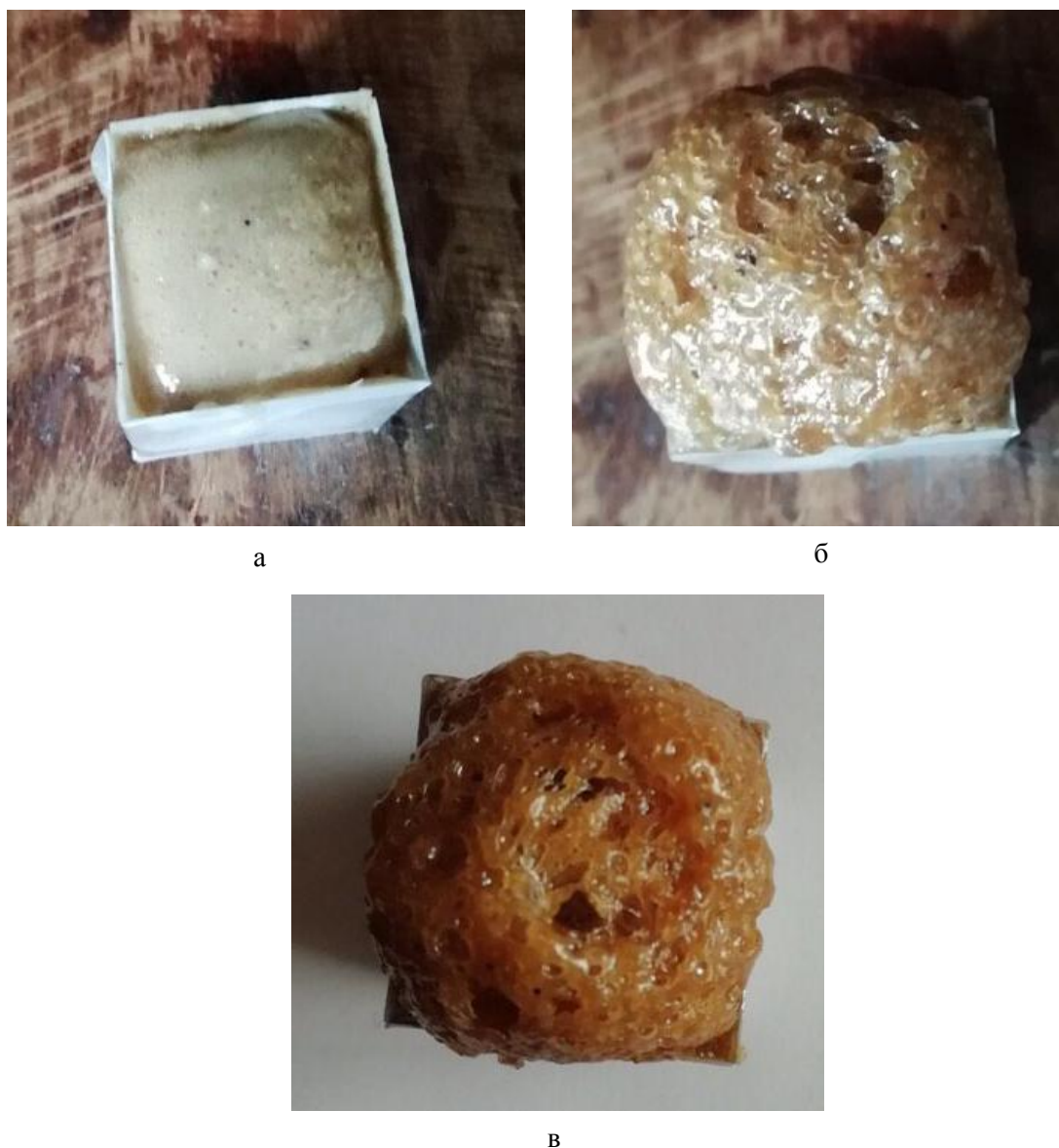
Рис. 2. Загальний вигляд епоксикомпозитів після термічної обробки з витримкою у сушильній шафі: а – 5 хв; б – 10 хв; в – 15 хв
