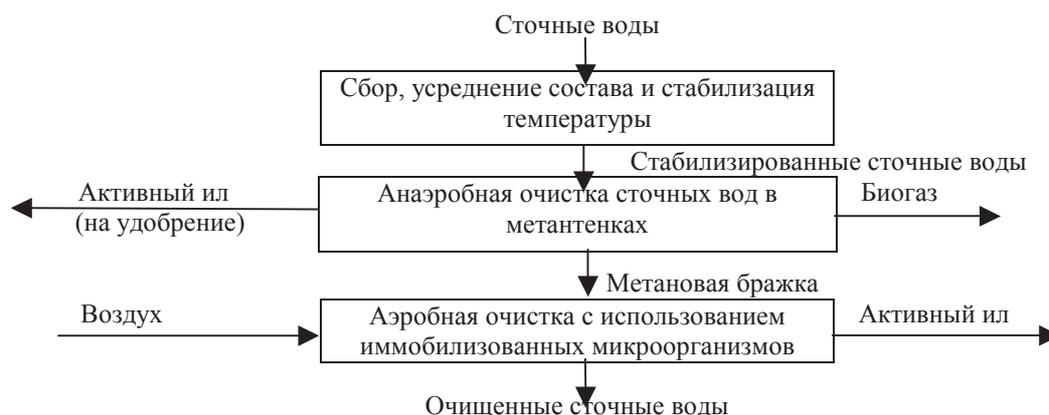
Рис. 1 – Принципиальная технологическая схема двухступенчатой очистки сточных вод
