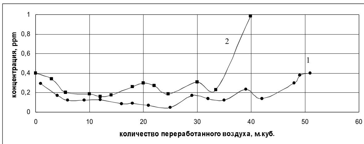
Рис. 2 – Зависимость концентрации диоксида углерода от количества переработанного воздуха
