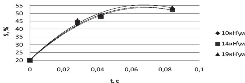
Рис. 3 – Залежність кінцевої сухості від часу пресування при різних лінійних тисках та температурі поверхні валу 150 °C і масі картону 160 г/м<sup>2</sup>
