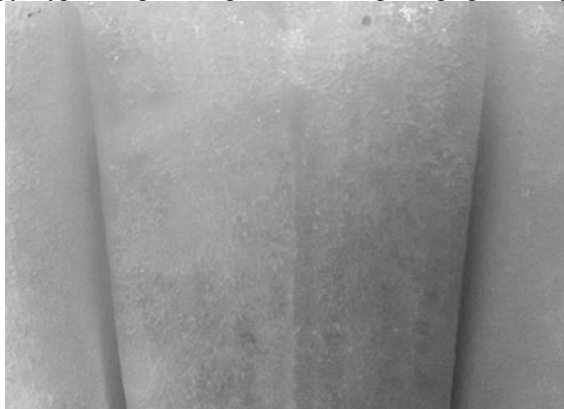
Рис. 4 — Пориста структура блоку льоду отриманого в установці блочного виморожування
