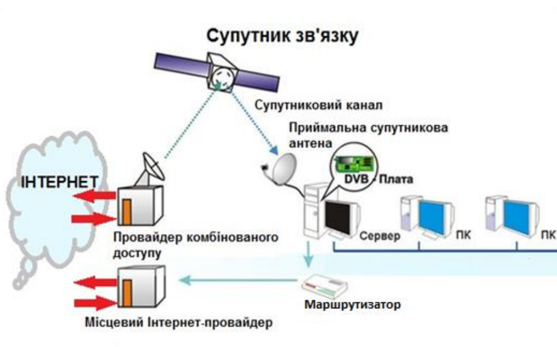
Рисунок 1 – Архітектура гібридної системи супутникового зв'язку
