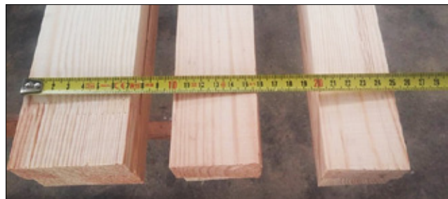
Рис. 3. Заготовки для профілю стулки
