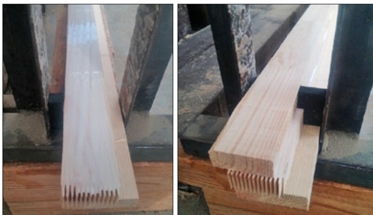
Рис. 4. Процес формування тришарового профільного клеєного бруса складного перетину
