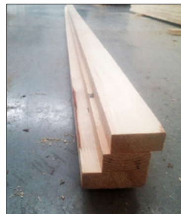
Рис. 5. Тришаровий профільний клеєний брус складного перетину для стулки
