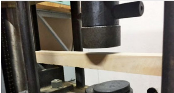
Рис. 8. Проведення експерименту на статичний згин
