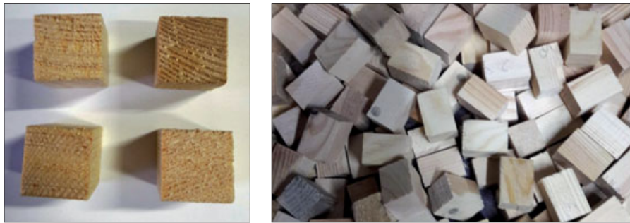
Рис. 2. Види зразків для експерименту на статичну твердість і стискання Fig. 2. Types of specimens for the experiment on static hardness and compression
