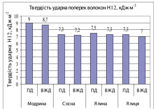
Рис. 5. Порівняльні дані показників ударної твердості шпилькових порід
