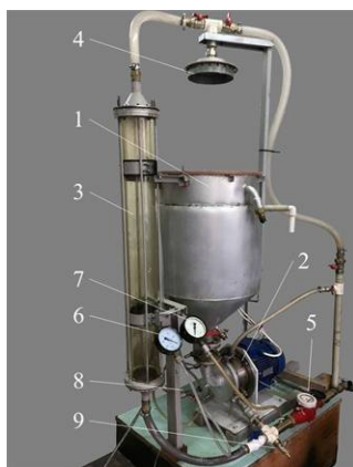
Рис. 1. Аераційно-окиснювальна установка роторного типу (АОРТ):
