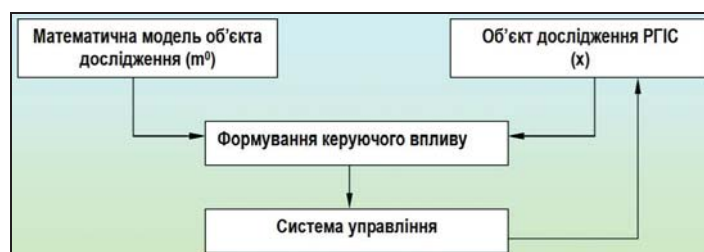
Рис. 3. Схема вибору об’єкту управління за заданою моделлю
