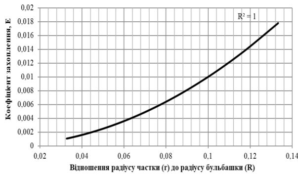
Рис. 1. Залежність коефіцієнту захоплення (E) від відношення розміру частки забруднення (діаметром 2 мкм) до розміру повітряної бульбашки.
