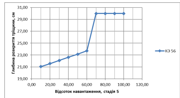
Рис. 11. Графік залежності глибини розкриття тріщини в кінцевому елементі №56 в залежності від відсотку навантаження в стадії 5
