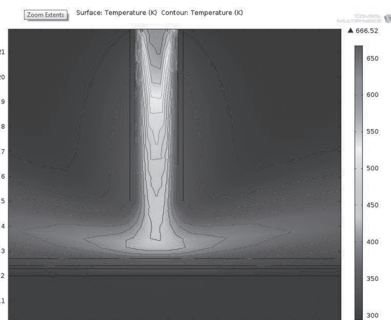
Рис. 1. Результат моделювання процесу поширення теплового поля на поверхні дефекту, індуковане тепловим потоком через пряме сопло
