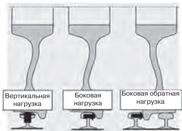
Рис. 2. Позиции и направления механических нагрузок в паре колесо – рельса при эксплуатации
