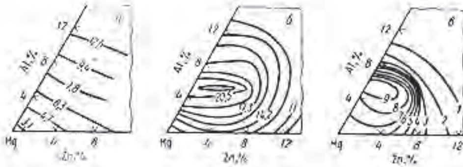
Рис. 1. Влияние элементов на механические свойства сплавов системы Mg–Al–Zn в литом состоянии [1]: а – \sigma_{0,1} ; б – \sigma_v кгс/мм 2 ; в – \delta , %
