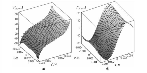
Рис. 8. График аппроксимации зависимости проекций магнитной силы полным степенным многочленом пятого порядка функции двух переменных  $\rho = [-\delta_{\rm r}, \ \delta_{\rm r}]$  и  ${\bf z} = [-1,7\delta_{\rm a}, \ 1,7\delta_{\rm a}]$ :  ${\bf a}) - F_{M_{\rm D}}(\rho,z); \ {\bf 5}) - F_{M_{\rm Z}}(\rho,z)$
