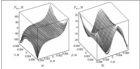
Рис. 9. График аппроксимации зависимости проекций магнитной силы полным степенным многочленом пятого порядка функции двух переменных  $\rho = [-\delta_{\rm r}, \, \delta_{\rm r}]$  и  ${\bf z} = [-3\delta_{\rm a}, \, 3\delta_{\rm a}]$ :  ${\bf a}) - F_{M\rho}(\rho, z); \, {\bf \delta}) - F_{Mz}(\rho, z)$
