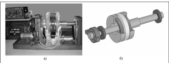
**Рис. 1.** Лабораторная модель ротора в комбинированном магнитном подвесе: а) – экспериментальная; б) – геометрическая
