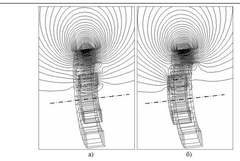
**Рис. 3. Эквипотенциальные линии магнитного поля МППКМ с осевой намагниченностью:** а) — при центральном положении внутреннего магнита; б) — при смещении внутреннего магнита вдоль оси неподвижного магнита
