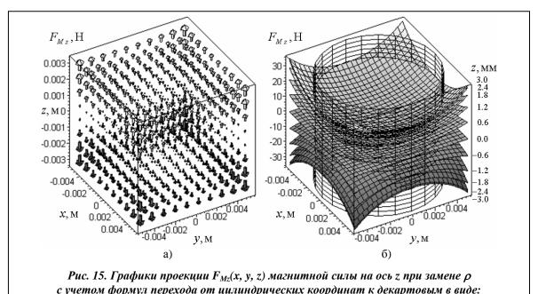
а) — векторного поля; б) — 3D-поверхностей при указанных значениях zТакое несоответствие не позволяет отказаться от зависимости проекций  $F_{Mx}$  и  $F_{My}$ магнитной силы на оси декартовой СК от переменных у и х соответственно и использовать упрощенные зависимости (2), так как это может привести к неадекватности математической
