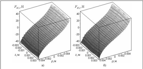
Рис. 5. График аппроксимации зависимости проекции  $F_{M\rho}(\rho, z)$  магнитной силы на ось  $\rho$  полным степенным многочленом функции двух переменных  $\rho$  и z:
