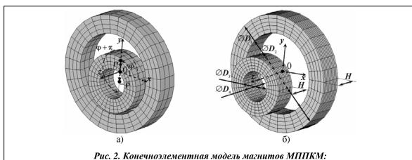
а) – при смещении внутреннего магнита только в радиальном направлении; б) – при общем положении внутреннего магнита
