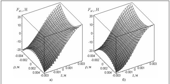
Рис. 7. График аппроксимации зависимости проекции  $F_{Mz}(\rho, z)$  магнитной силы на ось z полным степенным многочленом функции двух переменных  $F_{Mz}(\rho, z)$  и z:
