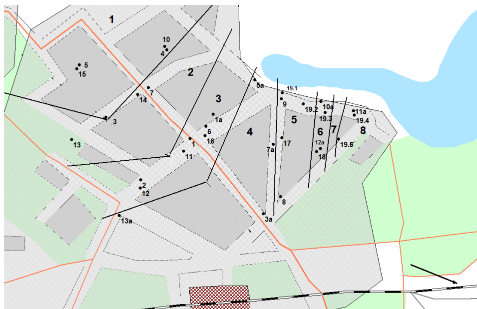
Рис. 1. План г. Припять с точками расположения пунктов измерений МЭД. Стрелкой показано направление на ЧАЭС. Выделены зоны города с различным уровнем радиоактивного загрязнения.
