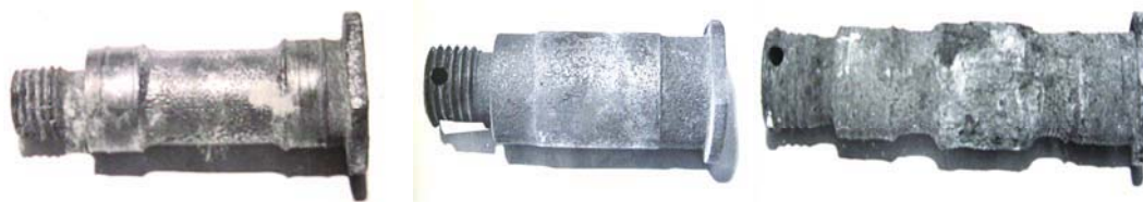
Рис. 1. Общий вид изношенных валиков шарниров подвесных устройств
