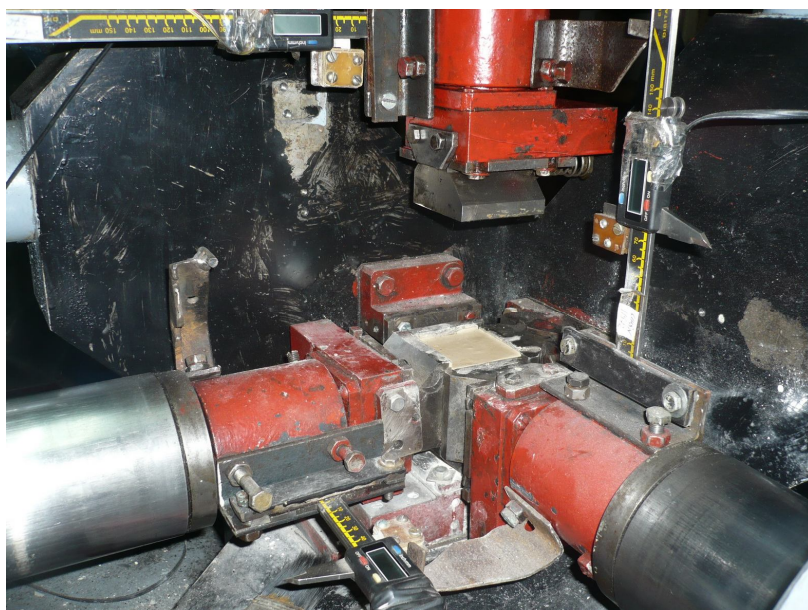
Рис. 1. Пластифицированный НРС помещенный в испытательную камеру установки УНТС
