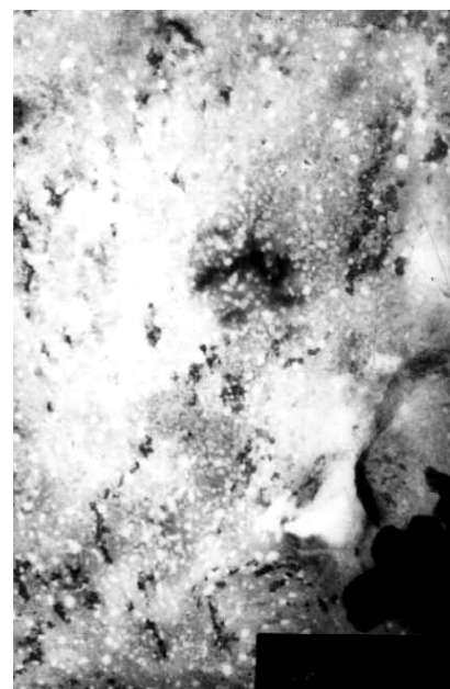
Рис. 2. Мікроструктура закристалізованого конденсату \text{YFeGe}_2 , отриманого при кімнатній температурі підкладки та відпаленого до 680 \text{ K} (X 16000).
