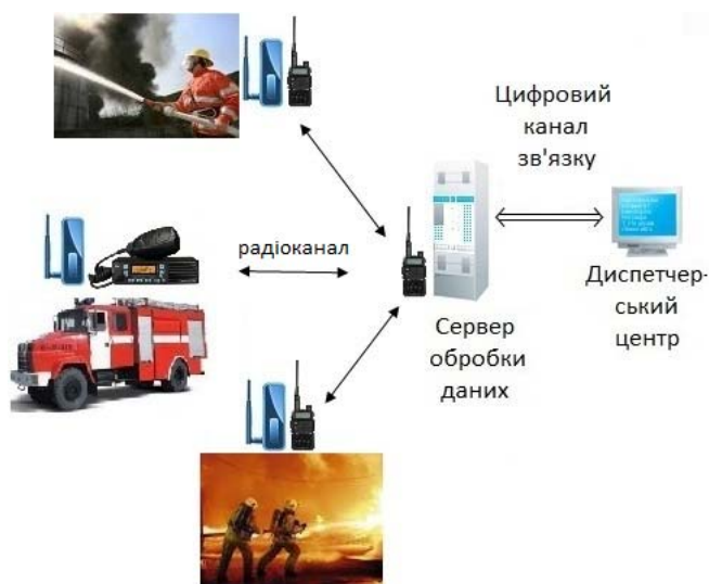
Рис. 2. Передача даних ПЗВІ по радіоканалам управління
