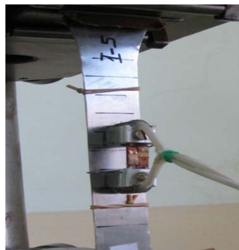
Рисунок 2 – Образец с тензодатчиком, установленный в испытательную машину
