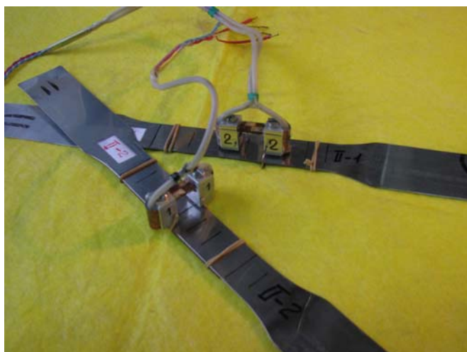
Рисунок 1 – Тензодатчики для определения продольной и поперечной деформаций, установленные на образцах
