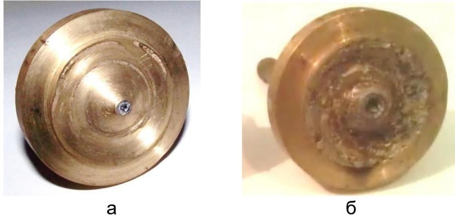
Рисунок 1 – Катодная вставка опытного образца плазмагенератора (а) до работы и (б) после работы
