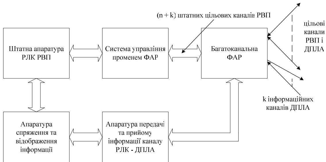
Рис. 2. Узагальнена структурна схема інтеграції наземної апаратури
