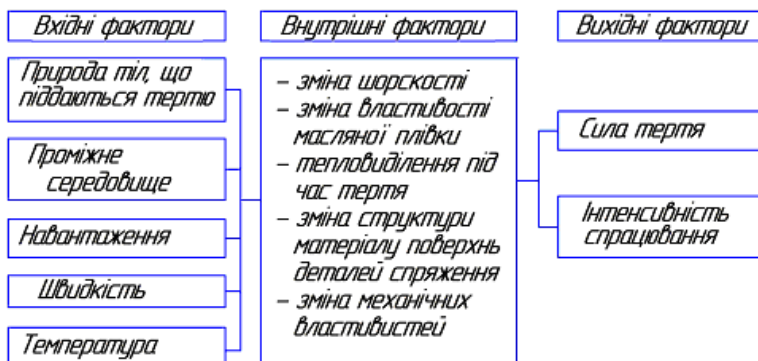
Рис. 1. Схема основних факторів фрикційної взаємодії зубчастої передачі
