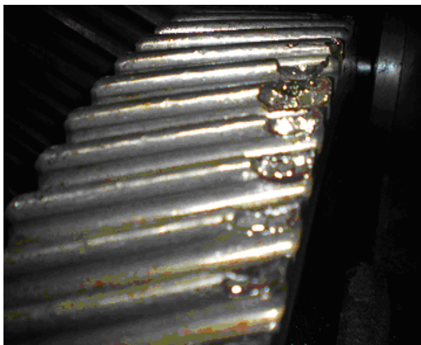
Рис. 4. Поверхнєве втомне викришування
