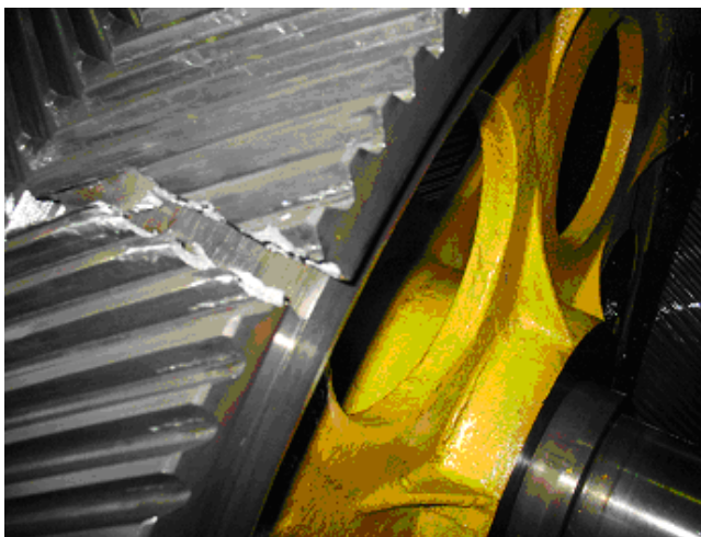
Рис. 5. Руйнування вінця зубчастого колеса
