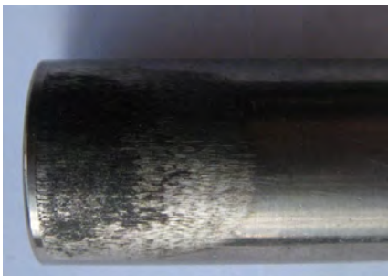
Рис. 7. Пошкодження хімікелевого покриття на циліндричній поверхні повзуна внаслідок тертя о поверхню розподільної трубки
