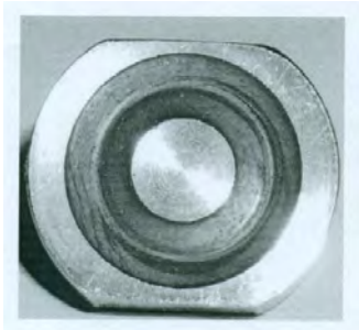
Рис. 5. Канавка на гумовій поверхні гумового ущільнення, що утворилася під впливом експлуатаційних навантажень
