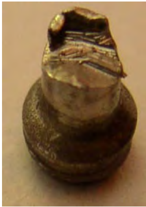
Рис. 9. Руйнування шийки штока від втоми (матеріал – сталь 08X18H10)
