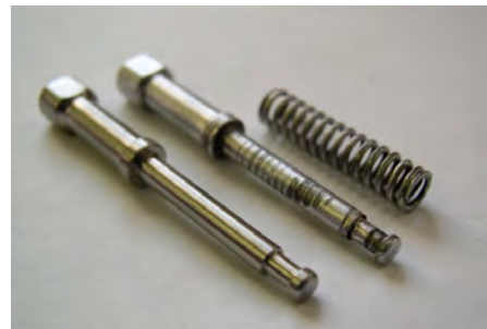
Рис. 8. Пошкодження покриття циліндричній поверхні штока внаслідок тертя о буферну пружину
