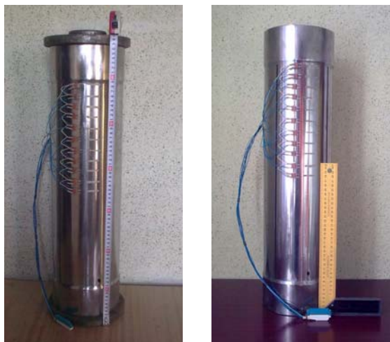
Рис. 3. Зразки об'єктів дослідження з наклеєними тензодавачами
