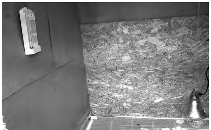
Рис. 1. Вимірювання параметрів мікроклімату в приміщенні для курчат-бройлерів під брудером
