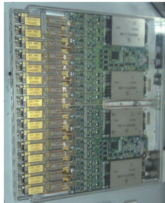
Рис. 1. Модулі вихідного підсилювача потужності з одностороннім [21] (а) та двостороннім [22] (б) розташуванням тепловіділяючих елементів
