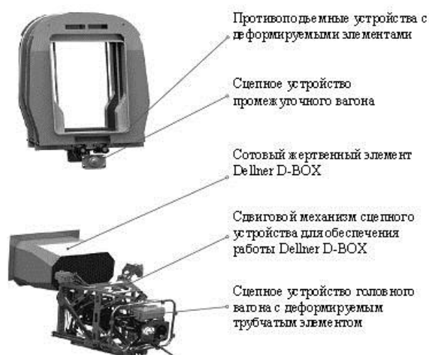
Рис. 5 – Элементы межвагонных соединений и СПБ Dellner
