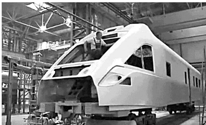
Рис. 10 – Элементы СПБ головного вагона электропоезда ЭКр1
