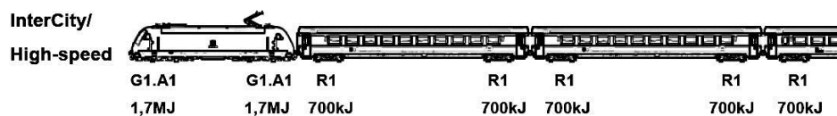
Рис. 1 – Схема европейского пассажирского поезда Inter city с СПБ (EST Eisenbahn-Systemtechnik GmbH)
