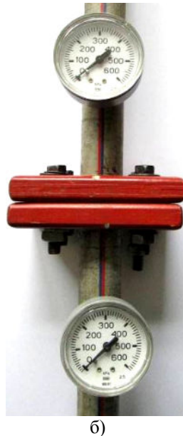
Рис. 8. Схема (а) роботи експериментальної установки для визначення перепаду тиску при проходженні повітря через пористий зразок та її загальний вигляд (б)
