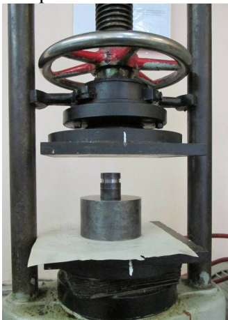
Рис. 5. Пресування пористих зразків на вертикальному гідравлічному пресі
