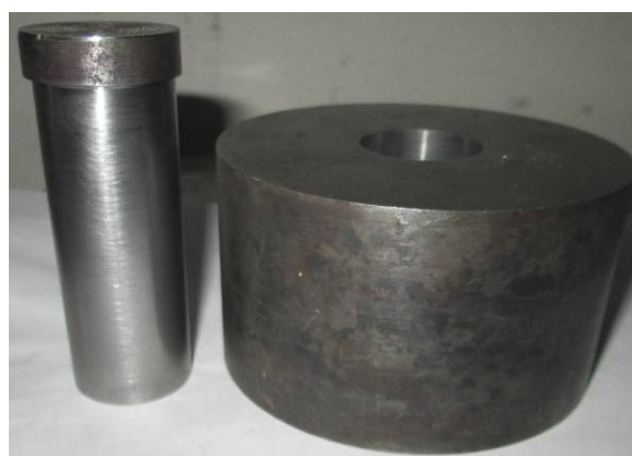
Рис. 4. Матриця з пуансоном для виготовлення зразків у формі шайби з Ø30мм
