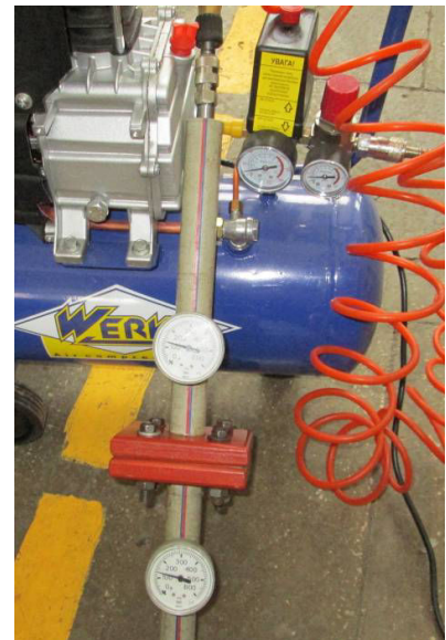
Рис. 9. Експериментальний стенд для визначення перепаду тиску повітря при його проходженні крізь пористий зразок
