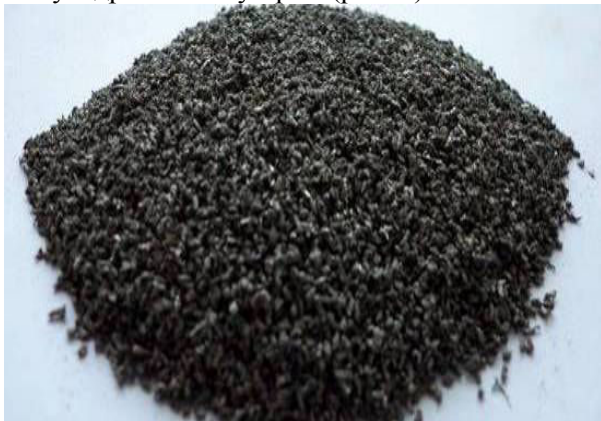
Рис. 3. Порошок марки ПТХ-1 на основі титану
