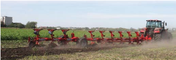
Рис. 1 – Причіпний обертовий плуг ППО.9.30/45, агрегований з трактором “Беларус 3522” під час оранки (традиційна система обробітку ґрунту)
