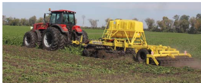
Рис. 6 – Борона важка модернізована БДВПА-4,2 МОЗ (Україна), агрегована з трактором “Беларус 3022 ДЦ.1” під час мілко розпушування ґрунту (мульчувальна система обробітку ґрунту)
