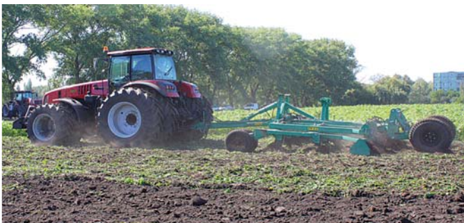
Рис. 2 – Глибокорозпушувач ГР-5,4 (Україна), агрегований з трактором “Беларус 3522”, під час глибокого розпушування ґрунту (консервувальна система обробітку ґрунту)
