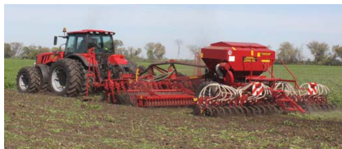
Рис. 7 – Агрегат ґрунтообробний посівний АПП-6Д (Білорусь), агрегований з трактором “Беларус 3022 ДЦ.1”, під час сівби по необробленому сидерату (підсистема обробітку ґрунту mini-till)
