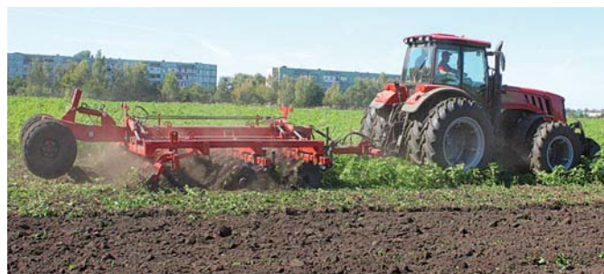
Рис. 5 – Агрегат ґрунтообробний комплексний АГК-5,4 (Україна), агрегований з трактором “Беларус 3022 ДЦ.1”, під час мілко розпушування ґрунту (мульчувальна система обробітку ґрунту)
