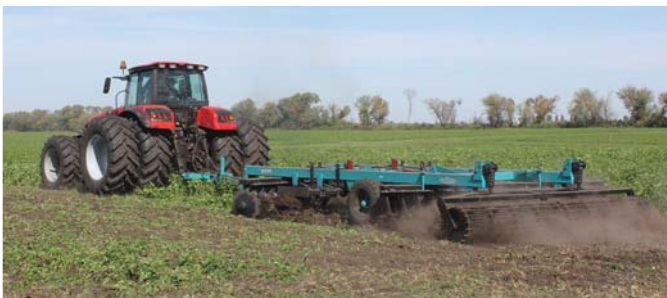
Рис. 3 – Глибокорозпушувач БДВП-4,2 (Україна), агрегований з трактором “Беларус 3522”, під час глибокого розпушування ґрунту (консервувальна система обробітку ґрунту)
