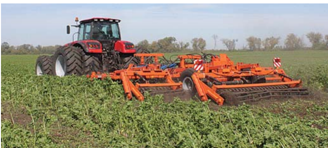
Рис. 4 – Агрегат універсальний комбінований АДУ-6АК (Білорусь), агрегований з трактором “Беларус 3522”, під час глибокого розпушування ґрунту (консервувальна система обробітку ґрунту)
