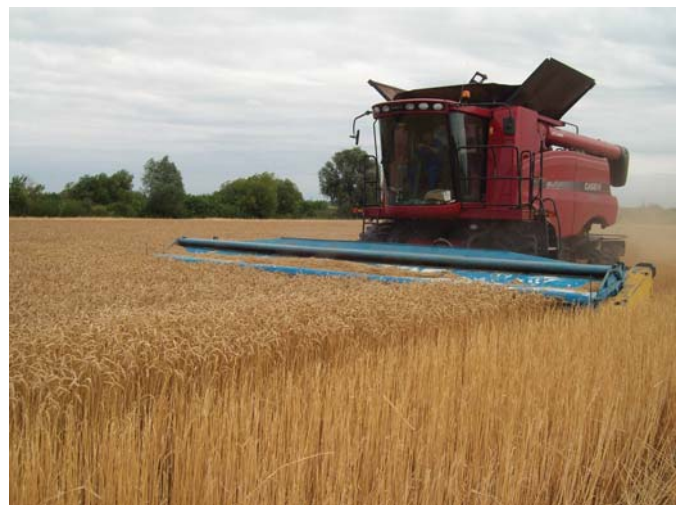
Рис. 2 – Обчисувальна жнивварка в агрегаті із комбайном CASE-IH при збиранні прямих хлібів
