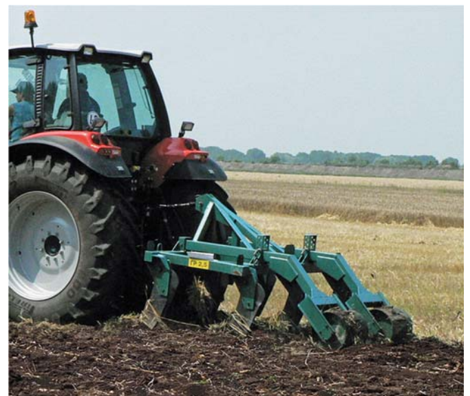
Рис. 3 – Глибокорозрихлювач ГР в роботі
