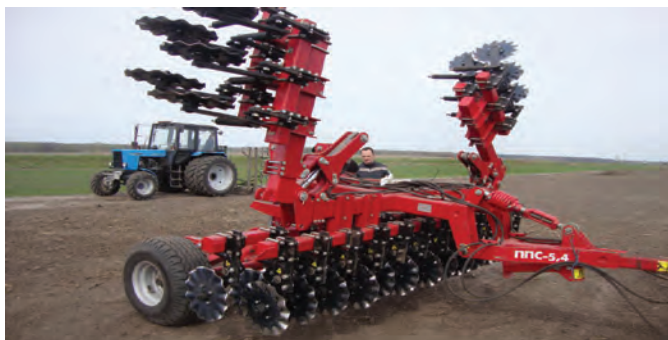
Рис. 1 – Загальний вигляд приставки прямої сівби типу ППС
