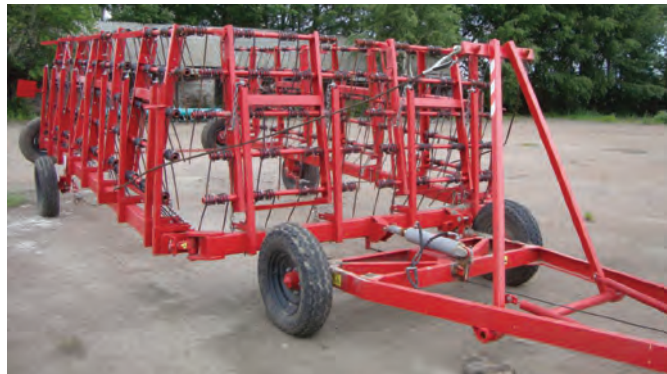
Рис. 2 – Загальний вигляд агрегату-зчіпки причіпної гідрофікованої боронувальної серії ЗПГ
