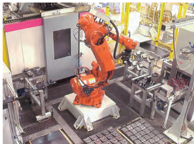
Рис. 4 – Роботизоване обладнання для обробки радіально-поршневих насосів
