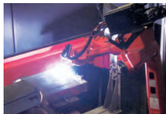
Рис. 2 – Роботизований комплекс для зварювання алюмінієвих теплообмінників
