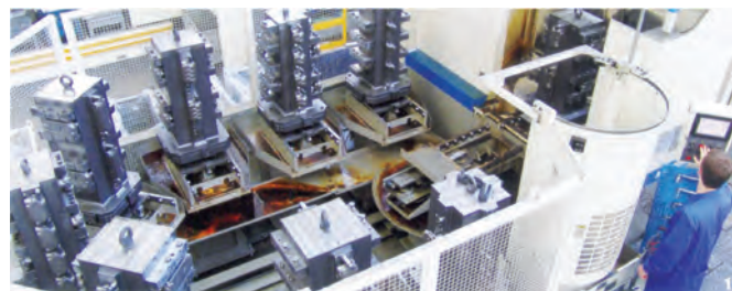
Рис. 5 – Роботизоване обладнання для обробки корпусів розподільчих клапанів
