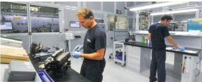
Рис. 8 – Цех для випробування шестеренчастих аксіально-поршневих насосів і двигунів
