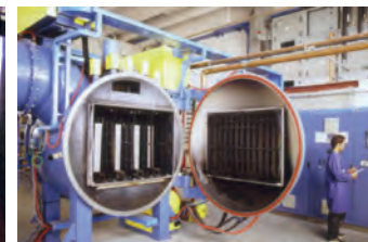
Рис. 3 – Високотемпературна вакуумна піч для зварювання корпусів радіаторів
