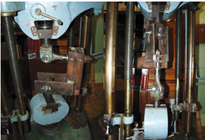
Рис. 2 – Обладнання для випробування зчіпних пристроїв тракторів та сільськогосподарських машин
